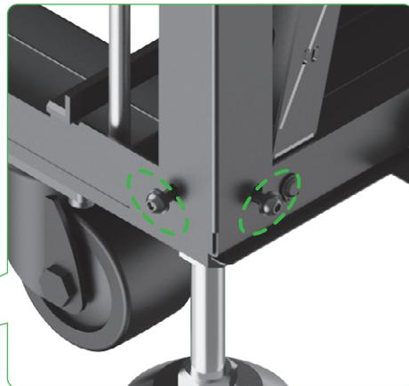
(3) 以相同方式固定其余三根长固定条。最后,用 L 形扳手拧紧四根长固定条上的螺丝。
