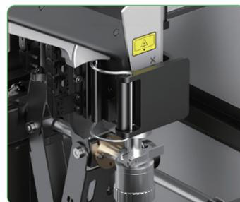
(5) 将焊枪线缆的三个固定环卡至机器的内部卡槽。
