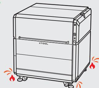
设备加工过程中, 若靠近内部加工区域边缘, 火花可能从设备底板四周溅出。因此, 请确保设备周边没有放置易燃材料、爆炸物或挥发性溶剂。操作人员须远离火花溅出区域, 距离至少 50 厘米。
